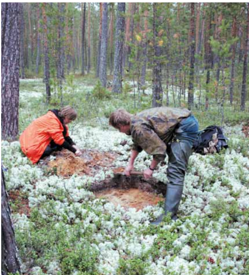
Рис. 12. Шурф на оси проектируемого коридора коммуникаций Приобского месторождения нефти ООО «РН-Юганскнефтегаз»
