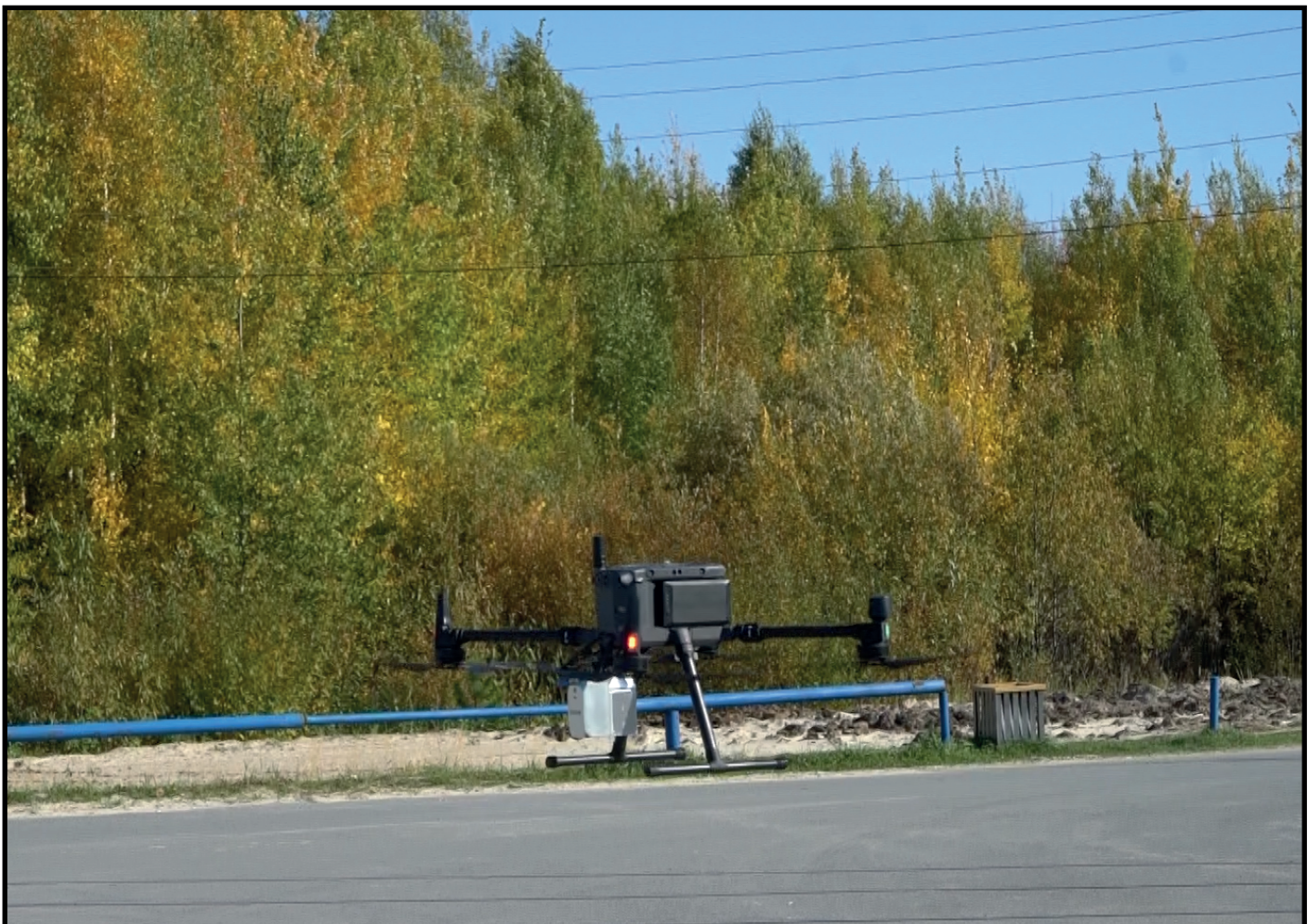
Фото 11. ХМАО-Югра, с.п. Салым, ДМ «Сырковский Сор». Методика топосъемки территории берега оз. Сырковский Сор. Начало съемки лазерного аэросъемочного сканера AlphaAir 450. Старт с площадки. Сентябрь 2022 г.
